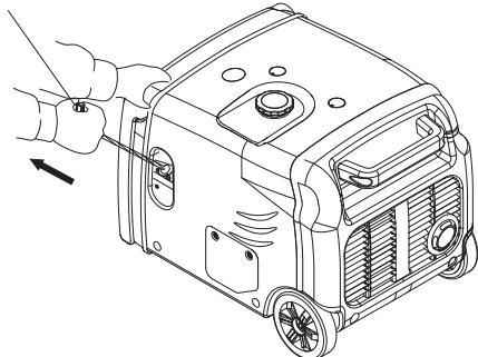
9.3. Schimbați cu ulei nou în timp ce motorul este încă cald de la funcționare.
