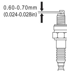
8.3.4. Măsurăți distanța dintre electrozi cu un dispozitiv de măsurare. Valoarea normală: 0,6-0,7mm (0,024-0,028in). Reglați spațiul prin îndoirea cu atenție a unuia dintre electrozi.
