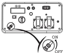
5.2.2. Rotiți comutatorul motorului în poziția „RUN / REMOTO”.
