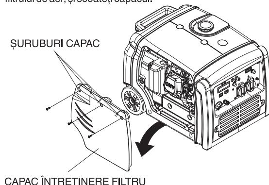
8.2.2. Slăbiți șuruburile capacului filtrului de aer și scoateți capacul.
