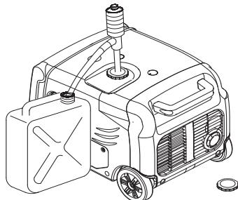
b. Rotiți comutatorul de combustibil în poziția „ON” (deschis) și slăbiți șurubul de scurgere al carburatorului pentru a evacua benzina din interiorul carburatorului.
