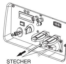
7.5) Rotiți comutatorul motor în poziția „STOP” sau apăsați butonul „STOP” (semn grafic) al controlerului.
