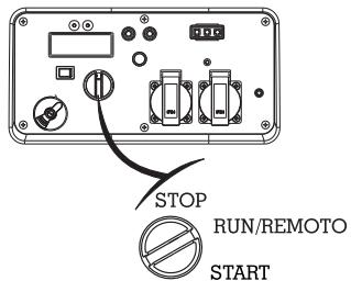
5.2.3. Alegeti unul din modurile de pornire pentru a porni motorul.
