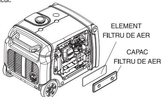
8.2.3. Scoateți elementul filtrului de aer și curătați-l cu solvent neinflamabil sau cu punct de aprindere ridicat, apoi uscați-l.
